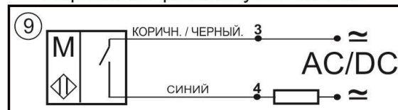
Схема подключения Нормально-разомкнутый контакт
